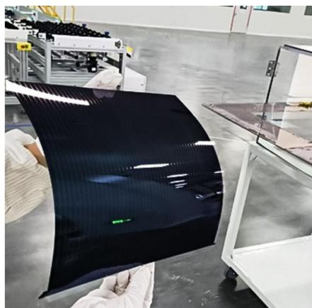
軽量かつ柔軟性を有する特長により、従来の太陽電池では実現が難しかった設置場所への対応が可能となり、建材、モビリティ分野などの多様な用途への応用を想定した展示を予定しております。
